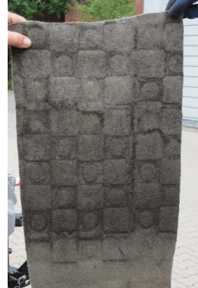
Figuur 9 Achterzijde van een stuk afgesneden geotextiel
