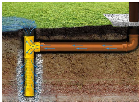
Figuur 15: Handmatig ingeboorde voorziening Bron: (pvcbuis, 2018)
