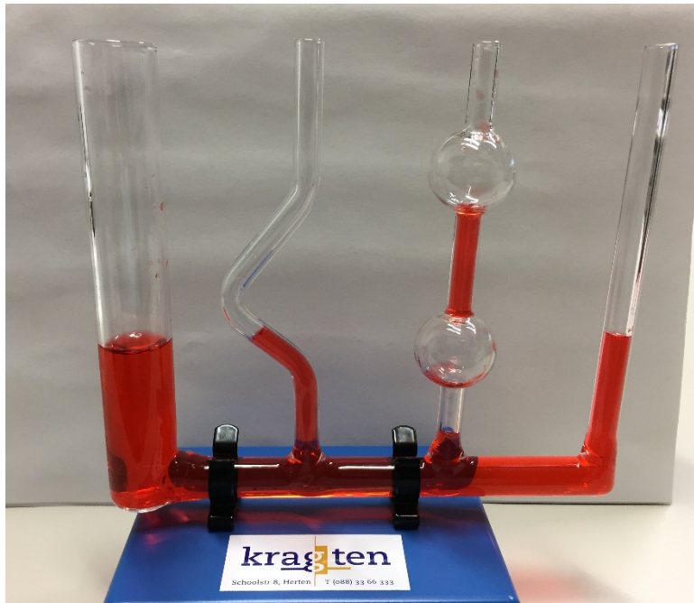
Figuur 18 simulatieopstelling communicerend vaten. Bron: (Evers)
